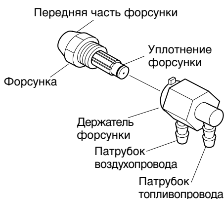
Рис. 22. Форсунка и держатель форсунки, нагреватель мощностью 10 кВт
