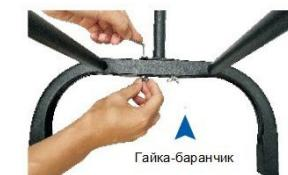
3. Приєднайте вертикальні стійки до опорних стійок (як показано на малюнку) і закріпіть їх за допомогою баранчикових гайок і L-подібного ключа (шестигранний ключ).
