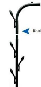
4. Вставте подвійну колінчасту підвісну трубку на верхню частину вертикальних стілок.
