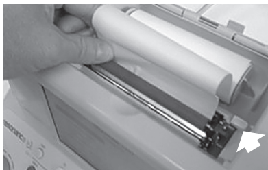
Важіль принтера блокується в положенні друку (вниз).
