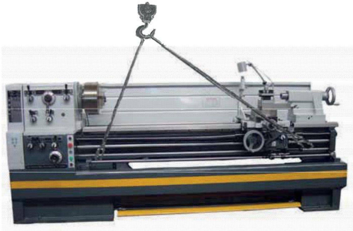
Мал. 4 Рекомендована схема стропування верстата
