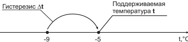
При этом охладительный элемент, управляемый терморегулятором, будет охлаждать морозильную камеру до  $-9^{\circ}\text{C}$  и отключаться. После повышения в ней температуры на  $4^{\circ}\text{C}$ , т.е. до  $-5^{\circ}\text{C}$ , терморегулятор снова включит охладительный элемент, начнется охлаждение и цикл повторится.
