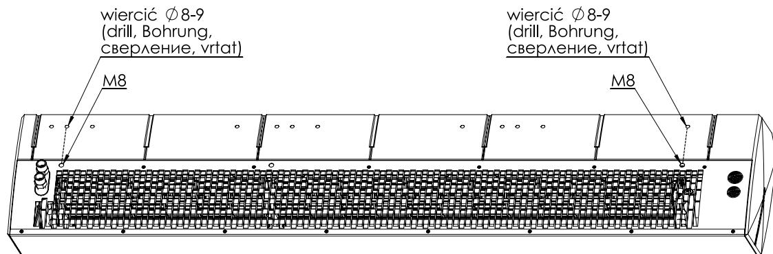
На рис. указаны монтажные втулки под шпильки.
