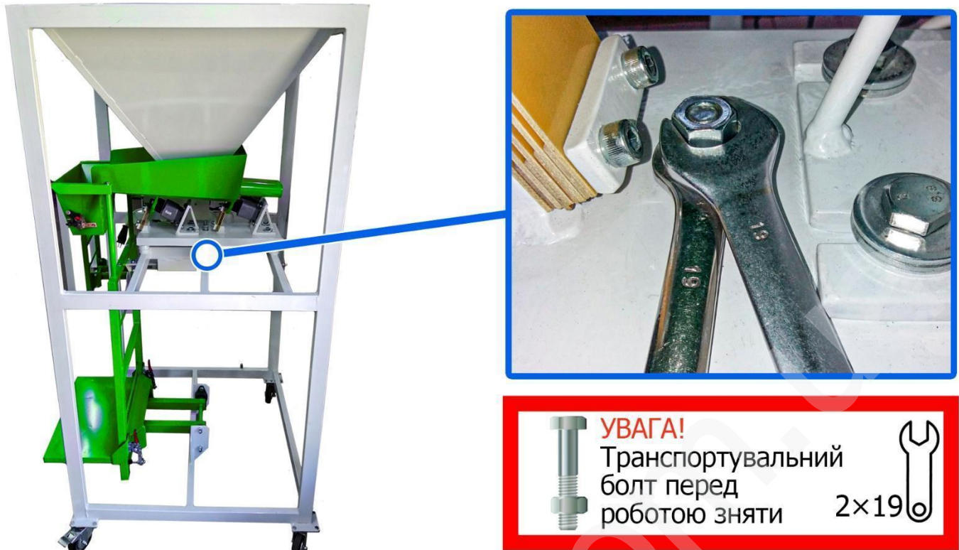
Схема 4 – Зняття транспортувального болта
