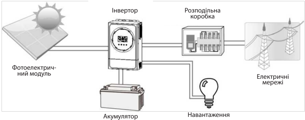
Малюнок 1 Загальний огляд фотоелектричної системи
