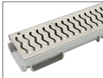
Низкопрофильный канал из ПВХ имеет длину 0,5 м и снабжен системой крепежа «мама-папа». Герметичность системы обеспечивается склеиванием ее компонентов. Малая глубина, всего 6 см, позволяет устанавливать каналы в ограниченном пространстве. Воронка-заглушка из ПВХ подходит к любой секции водоотводного канала, даже если он был подрезан до другой длины. Воронку также можно устанавливать на боковых сторонах канала, что позволяет выполнять угловые и поперечные соединения.
