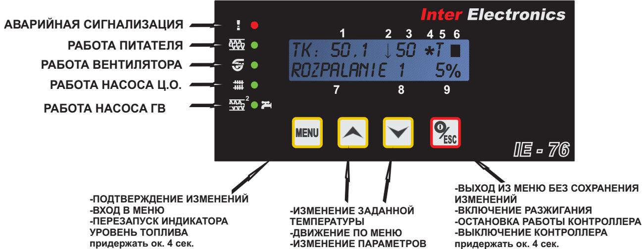
1. Измеренная температура на датчике котла
