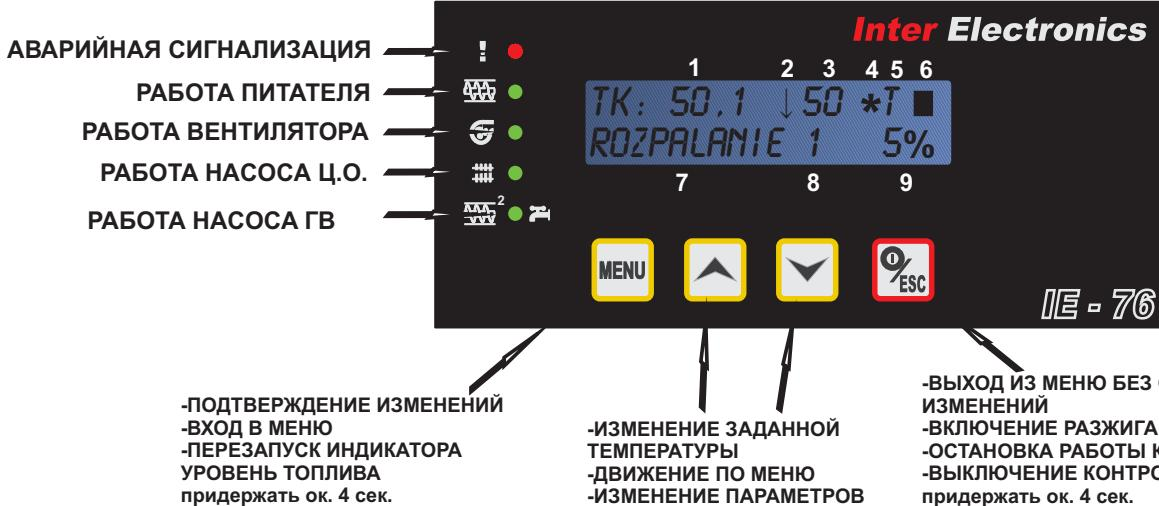
1. Измеренная температура на датчике котла
