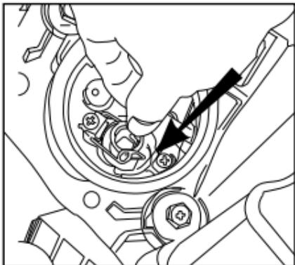
Встановіть LED лампу в перехідне кільце. В перехідному кільці є спеціальні пази, в які вставляються фіксатори на лампі.
