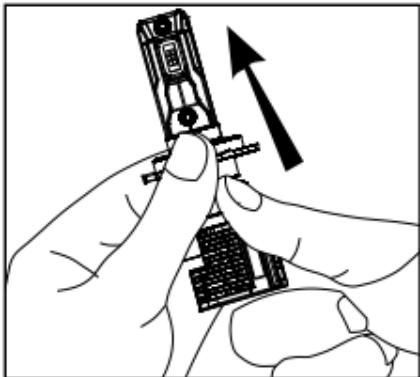
Встановіть перехідне кільце від LED лампи в штатне гніздо та зафіксуйте кільце штатним кріпленням.
