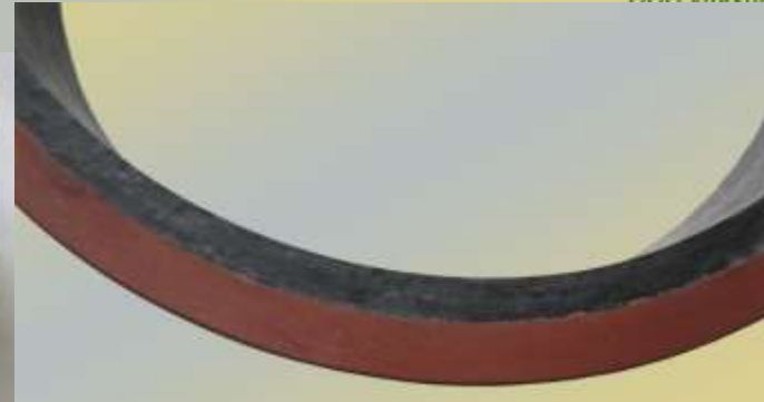
Ремни После восстановления резинового покрытия.
