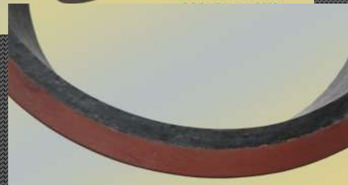
Ремені Після відновлення гумового покриття.
