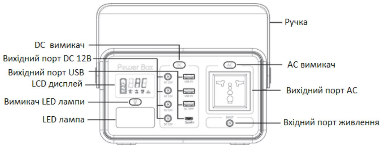
☆ Розетки змінного струму, вихідна напруга та частота змінного струму залежать від країни. Перед використанням ознайомтеся з інструкцією. Показники змінного струму вказані на корпусі приладу.
