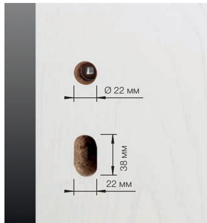
Підготовка двері під гарнітур Хоппен на міні-розетках з розеткою під ключ
