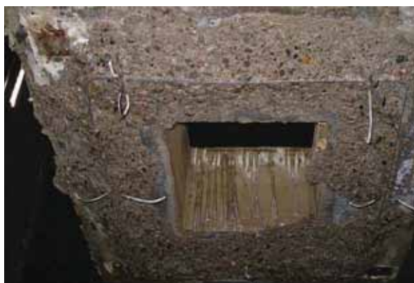
Сильная связка с бетоном! Бетон, соединяясь с CEMflex VB NG является более слабым местом чем само соединение бетон/CEMflex VB NG
