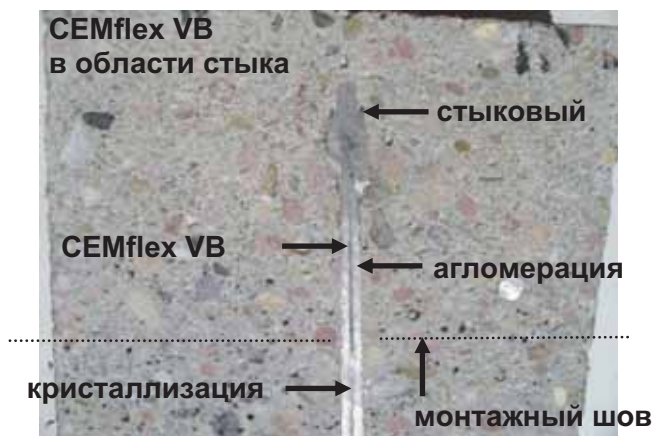
Область наложения с перехлестом CEMflex VB (только 5 см) при проникновении воды герметизируется автоматически! Данный процесс протекает очень быстро, т.е. за считанные часы (активная кристаллизация + активная агломерация).
