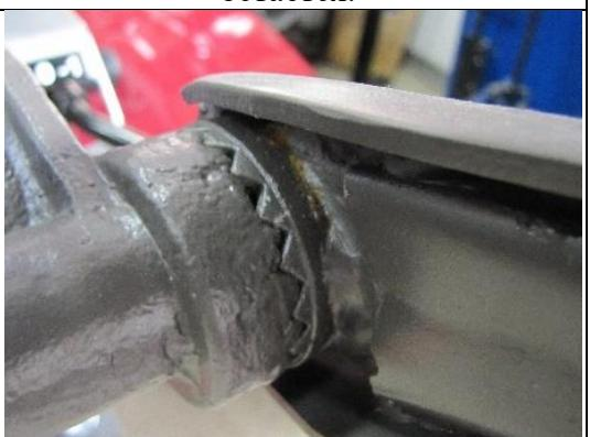
Точные зазоры на шестерёнчатой передаче, как следствие износ редукторов и КПП
