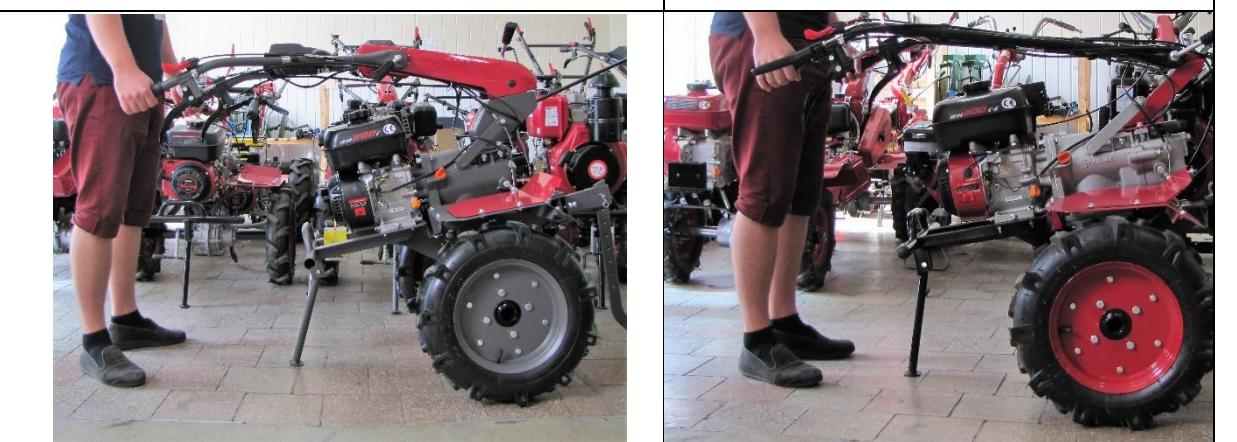
Зубцы регулировки руля выполнены очень качественно, обеспечивает лучшую фиксацию, нет люфтов, ничего не разбивается и не разбалтывается
