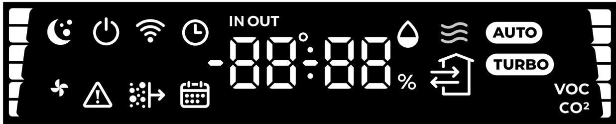
На цифровий сегмент дисплея виводиться інформація, така як час, температура, вологість чи всі дані по черзі. Також можна вибрати датчик температури для відображення (зовнішній, припливний, у приміщенні) та вибрати датчик CO<sub>2</sub> або VOC.
