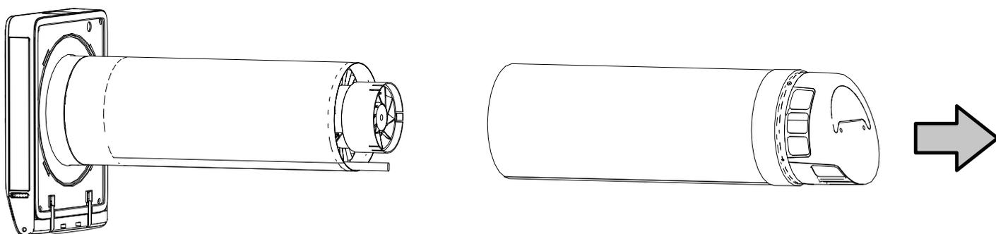
4. Встановіть повітропровід в отвір так, щоб його зріз збігався із внутрішньою поверхнею стіни.
