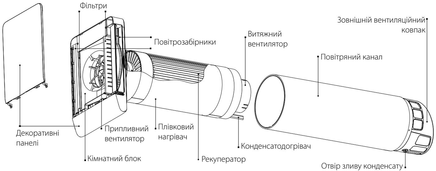
Під час роботи повітряні потоки пропускаються через рекуператор, розміщений у робочому модулі. Завдяки цьому відпрацьоване повітря віддає тепло припливному прохолодному, і здійснюється якісне провітрювання.
