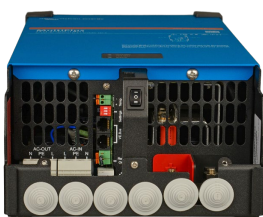
MultiPlus 2000 ВА (нижняя крышка снята)
