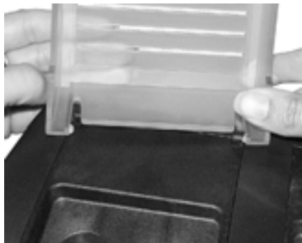
Afbeelding 5 Vervanging van de beschermkappen (Stap 2)
