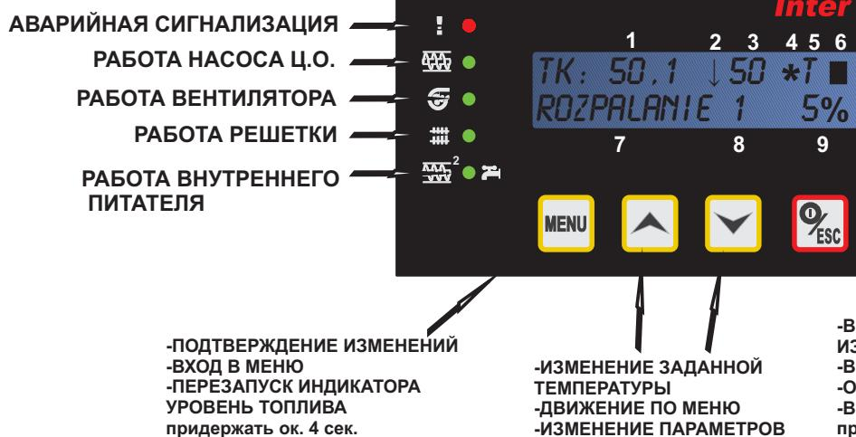
1. Измеренная температура на датчике котла
