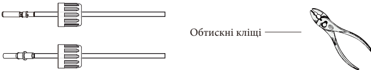
Рис. 5.4 Обтисніть контактний штифт до дроту
