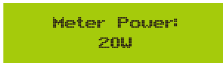
Рис. 7.21 Функція нульового експорту через увімкнення лічильника електроенергії
