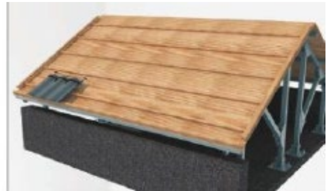
5-2-2.4 Укладка черепиц на крышку плоско-наклонного типа
