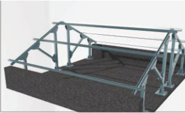
5-2-2.1 Стальная конструкция, монтаж стальных кровельных конструкций плоско-наклонных
