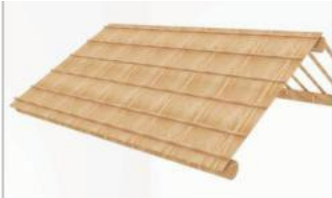
5-2-3.3 Установка деревянных реек
