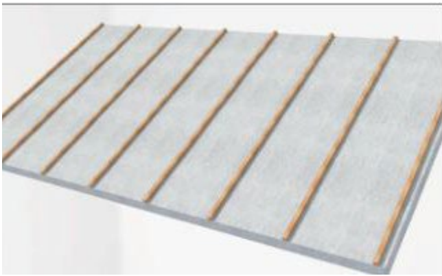
Рисунок 5-2-1.1 Установка контррейки на бетонной крыше
