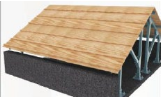
5-2-2.3 Монтаж из металлоконструкций крыши плоско-наклонного типа
