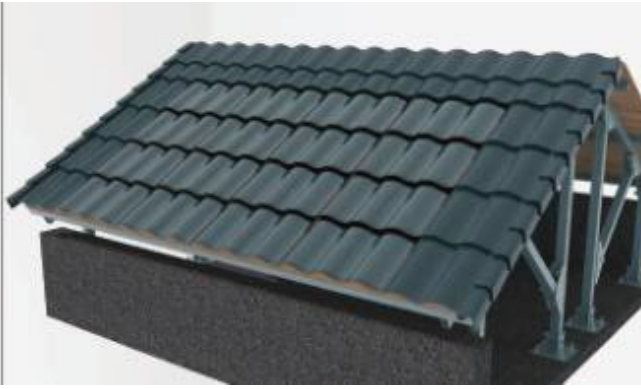
5-2-2.10 Установка боковой солнечной черепицы на крыше со стальной конструкцией, плоско-наклонной.
