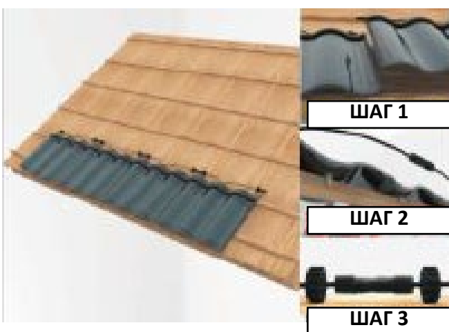
5-2-3.5 Конструкция деревянной крыши и установка солнечной черепицы на ней.
