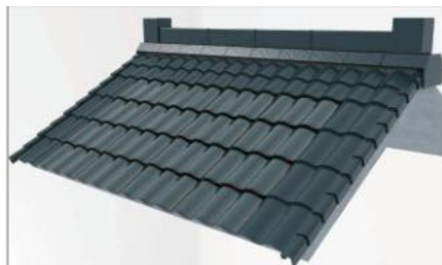
Рисунок 5-2-1.10 - Установка боковой плитки на бетонной крыше
