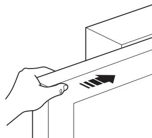
h - Установить на шестерню электропривода первую часть зубчатой рейки: проверить, чтобы она совпала с началом створки и что между шестерней и зубчатой рейкой обеспечивается расстояние 1 ч 2 мм (во избежание воздействия веса створки на электропривод)
