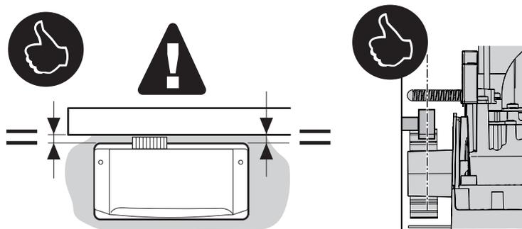
k - Проверьте, чтобы зазор между шестерней и зубчатой рейкой был равен примерно 1 ч 2 мм. В противном случае во избежание воздействия веса ворот на электропривод, отрегулируйте высоту электропривода с помощью регулировочных винтов без головок
