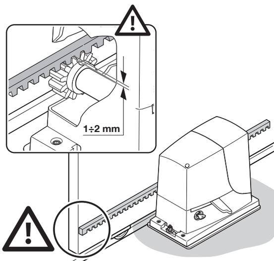
j - Проверьте правильность центрирования электропривода относительно створки ворот и зубчатой рейки
