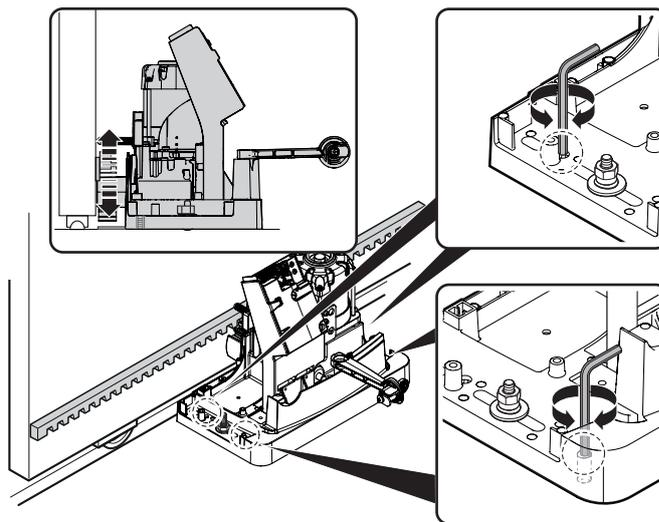
l - Передвинуть ручную створку, используя шестерню, как контрольную точку для закрепления других элементов зубчатой рейки
