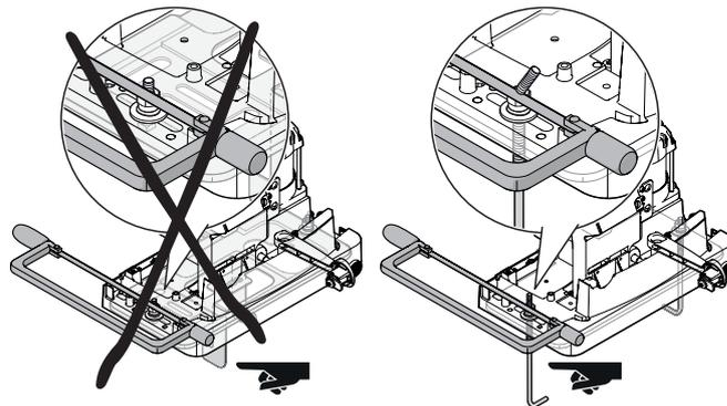
10. a - Установите на место кожух и закрепите его двумя винтами (1)
