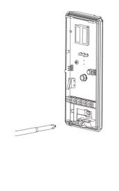
7. Снимите основание детектора с металлического кронштейна.
