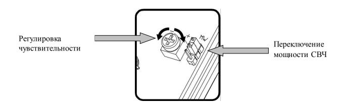
Регулировки чувствительности осуществляются потенциометром и СВЧ джамепром рядом с ним (положение стрелки потенциометра ориентировано как часовые стрелки)
