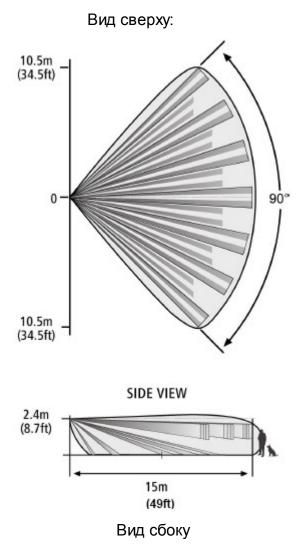
Благодаря наличию инфракрасного и микроволнового детекторов, EDS-2000 различает сигналы, генерируемые мелкими животными и человеком, и выдает сигнал тревоги корректно. ИК и СВЧ каналы детектора работают по логической схеме «И», т.е. тревога не будет сгенерирована, если при срабатывании ИК части детектора не будет подтверждение срабатыванием по СВЧ каналу, и наоборот.
