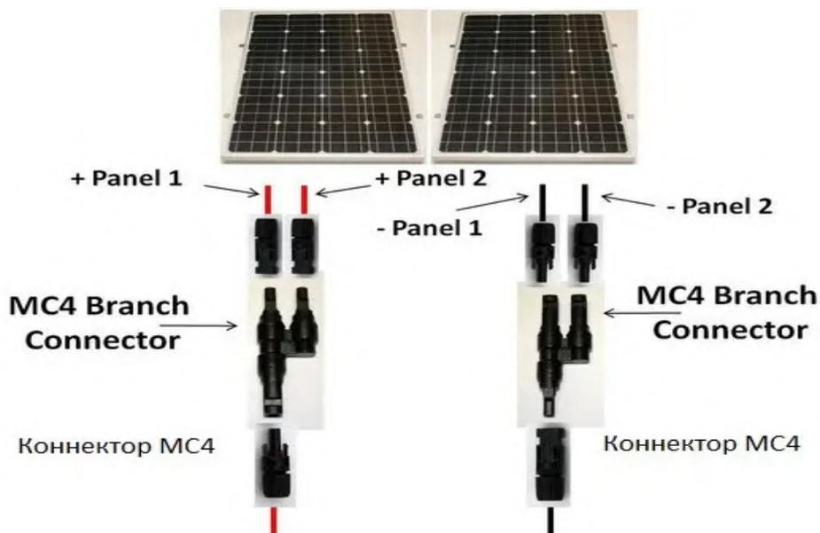
Для соединения двух солнечных батарей в параллель нужно два коннектора [MC4 T-Branch](#) (принято называть одна пара коннекторов MC4 T-Branch) и одна пара коннекторов [MC4](#).
