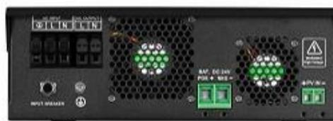
Так смотрится встроенный солнечный контроллер заряда в инвертор. По существу мы видим в одной части инвертор, в который встроен солнечный контроллер заряда, а в другой – терминалы подключения к инвертору и контроллеру.
