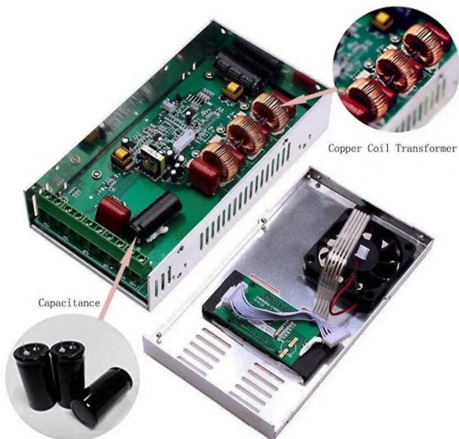
Плата MPPT солнечного контроллера заряда содержит габаритные катушки индуктивности Copper Coil Transformer, поэтому такой контроллер имеет больший вес, чем PWM.
