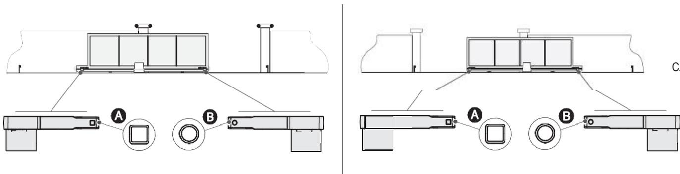
Все чертежи относятся к концевым выключателям, установленным с автоматикой, расположенной слева. Установка концевых выключателей справа является симметричной.
