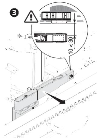
Прикрепите держатель к зубчатой рейке стопорными винтами (входят в комплект).
