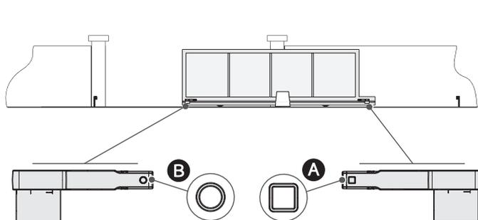
Следующие чертежи относятся к концевым выключателям, установленным с автоматикой, расположенной слева. Установка концевых выключателей справа является симметричной.
