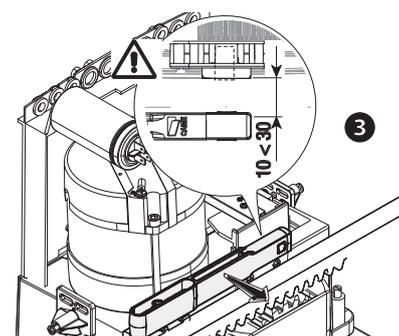
Прикрепите держатель к зубчатой рейке стопорными винтами (входят в комплект).
