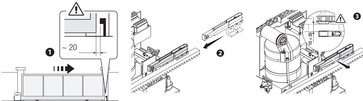
Прикрепите держатель к зубчатой рейке стопорными винтами (входят в комплект).
