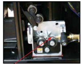
Подайте електродний дріт на привідний ролик таким чином, щоб дріт виходив за межі випускного отвору на 150-200мм. Зафіксуйте дріт прижимним роликком.
