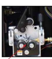
Встановіть ролики з відповідним розміром та типом канавки, який відповідає діаметру отвору контактного наконечника пальника, діаметру та виду електродного дроту.
