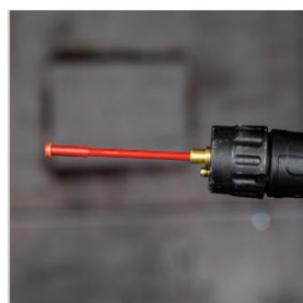
**Порядок проведення монтажу направляючого тефлонового** або поліамідного каналу дещо схожий з процесом монтажу спірального каналу, але має декілька відмінностей:
