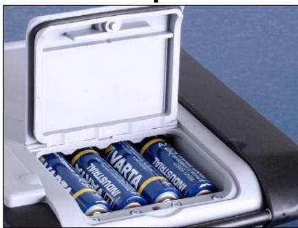
Время работы прибора CYM290 от четырех батарей АА в режиме регистратора данных (см. стр. 36) составляет до 500 часов. Откройте аккумуляторный отсек, расположенный на задней стороне прибора. Устанавливая батареи, соблюдайте полярность (см. маркировку в аккумуляторном отсеке). Закройте отсек и закрутите винт вручную.
