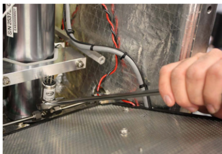
Рис. 38. Снятие датчика давления
