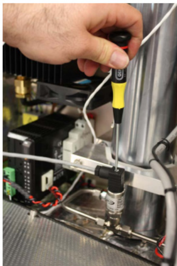
Рис. 36. Снятие крышки со жгута проводов
