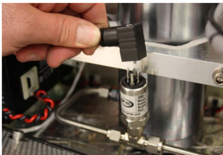
Рис. 37. Снятие крышки жгута проводов
