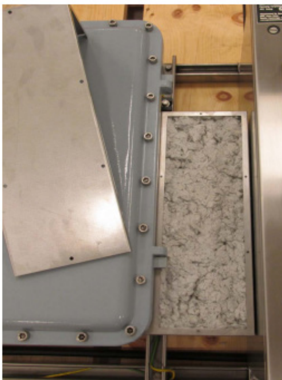
Рис. 41. Снятие изоляции корпуса
