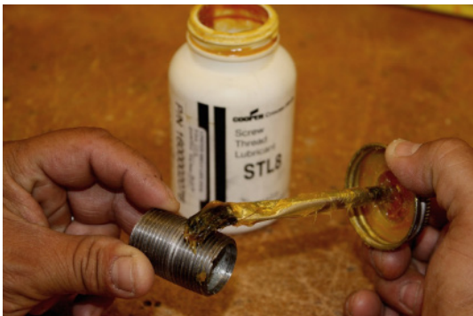
Рис. 25. Нанесение смазки на резьбу
