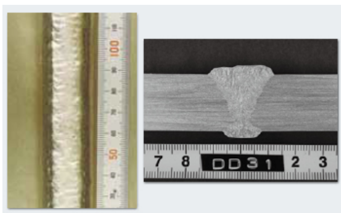
Иллюстрация 11: Внешний вид валика сварного шва и макроструктура шва, выполненного с DW-2594 в позиции 3G (защитный газ 80%Ar-20%CO2, 160A-26V)
