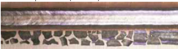
Иллюстрация 4: Удаляемость шлака и внешний вид валика сварного шва сразу после сварки (DW-308L)
