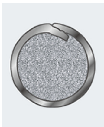
Иллюстрация 2: Схематическое изображение разреза присадочной проволоки с флюсовым сердечником компании Kobe Steel для нержавеющей стали
