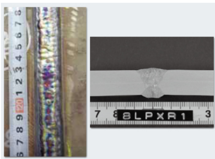
Иллюстрация 8: Внешний вид валика сварного шва и макроструктура стыкового шва, сварка в положении 3G с DW-308LP-XR
