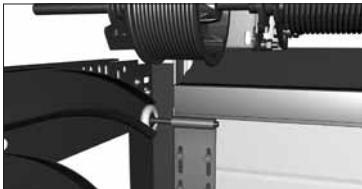
При сборке верхней панели установите верхние опоры ролика. Выровняйте края углового кронштейна по панели, просверлите 4 отверстия Ø4,2 мм и закрепите его при помощи саморезов для панелей ворот.
