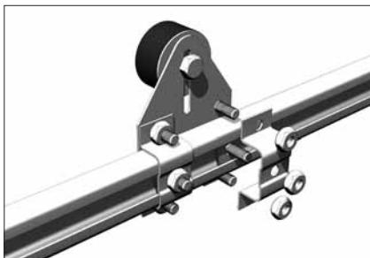
Буферы служат для ограничения хода полотна ворот при их открытии. Перед установкой буферов отверните болты с гайками и закрепите крепежные скобы с закладными пластинами на с-профиле с помощью болтов. Установите буферы симметрично относительно оси проема.
