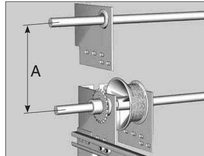
Установите на вал звездочку, предварительно вставив шпонку в шпоночный паз. Зафиксируйте звездочку на валу крепежными болтами M8x25 мм. Аналогично закрепите звездочку на валу с другой стороны проема.
