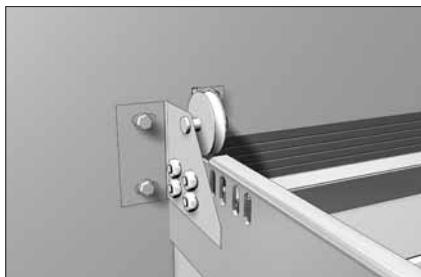
По отверстиям в угловой стойке установите шкив и зафиксируйте при помощи 4 болтов с полукруглой головкой M8Х16.
