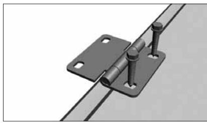
Закрепите петли при помощи 2-х саморезов.
