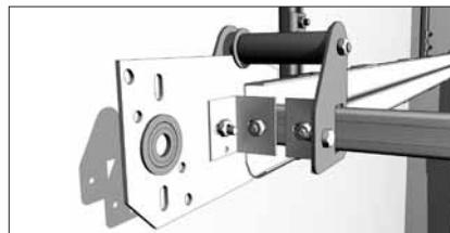
Установите и закрепите ролик, направляющий трос, для барабана сзади совместно с монтажным угольником для установки горизонтальной планки на концевом опорном кронштейне при помощи болта с гайкой. Установите и закрепите с-профиль с помощью монтажных угольников, закладных пластин болтами с полукруглой головкой M8x25 соответствующими гайками.
