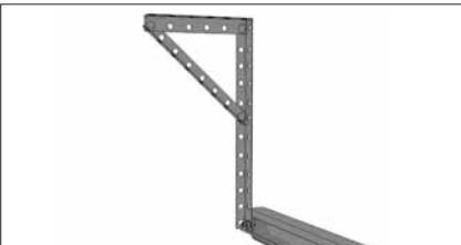
Приложите монтажный угольник к направляющим в месте крепления. Отметьте и просверлите отверстия в потолке. Закрепите монтажный уголок с помощью саморезов с шайбами и дюбелей.
