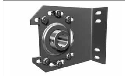
В случае установки вала 31,75 мм вместо обычных концевых опорных и универсального внутреннего кронштейнов используются кронштейны с регулируемым подшипником. Кронштейны имеют дополнительные отверстия для крепления к стене и угловой стойке.
