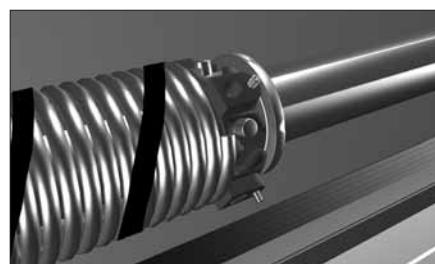
После взвешивания пружины зафиксируйте её, положив упоры под монтажные воротки, задвиньте в пазы окончания стопор, вытащите вороток. Затяните шестигранные винты крепления окончания пружины к валу.
