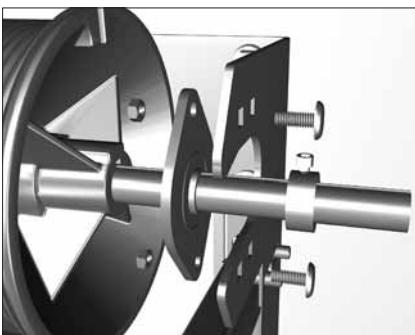
Закрепите пластину концевую с подшипником к п-образному кронштейну при помощи 2-х болтов (M10x25) с соответствующими гайками и шайбами. По аналогии закрепите торсионный механизм с другой стороны.
