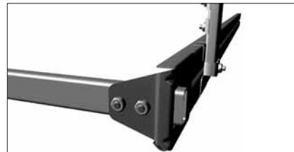
На кронштейн угловой соединительный закрепите 2 закладные пластины болтами 8Х25 мм с полукруглыми головками с гайками.
