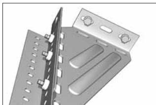
Крепление перфорированного уголка к направляющим ворот с низким подъемом производится через соединитель перфорированного уголка при помощи скобы болтов и гаек.
