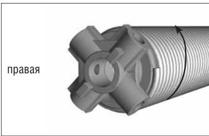
Направление закрутки пружин должно совпадать с направлением ее навивки. Т.е. для правой пружины направление закрутки должно осуществляться против часовой стрелки, а для левой – по часовой стрелке.
