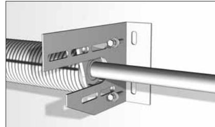
Просверлите намеченные отверстия  $\varnothing 12$  мм и закрепите промежуточный кронштейн при помощи саморезов с шайбами и дюбелей.
