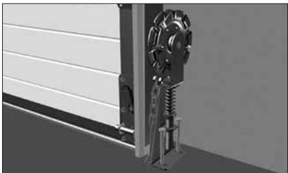
Установите натяжной ролик на полу, на одной оси с приводом. Разметьте и просверлите отверстия в полу для крепления натяжного ролика.
