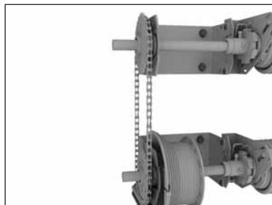
Установите на звездочки соединительную цепь. В зависимости от межцентрового расстояния расположения валов, укоротите цепь, согласно таблице указанной в монтажной карте.
