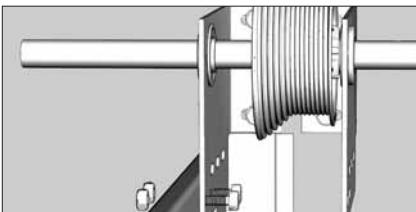
Вставьте вал с пружиной в подшипники кронштейнов и установите барабаны. Закрепите правый и левый опорные кронштейны к стене с помощью саморезов с шайбами и к угловым стойкам с с-профилями при помощи болтов с гайками.
