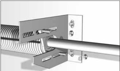
Установите подшипник во фланец окончания пружины, а затем закрепите фланец с помощью болтов M10x45 с гайками на универсальном внутреннем кронштейне.
