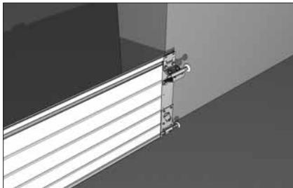
Перед установкой направляющих необходимо установить в проем нижнюю панель таким образом, чтобы ее края заходили за проем равномерно с двух сторон.
