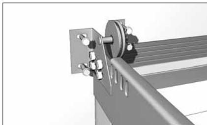
Вставьте дюбели и закрепите кронштейн шкива концевой к стене при помощи саморезов с шайбами.
