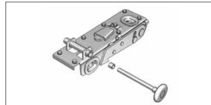
Распорные втулки служат для ограничения движения полотна ворот вдоль плоскости проема. Установите втулки на оси роликов в нижних верхних опорах.
