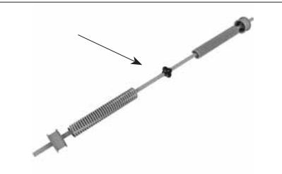
Соедините две части вала с помощью муфты вставив шпонки в шпоночные пазы обоих частей муфты. Затяните болты соединяющие две части муфты.
