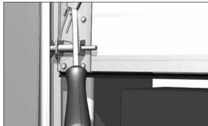
Приподнимите полотно ворот на ~150 мм и подложите деревянные бруски под углы полотна. Верхние плоскости брусков должны быть на одном уровне относительно друг друга. Опустите полотно ворот до момента касания его нижнего угла деревянного бруска. Второй угол останется приподнятым над бруском.
