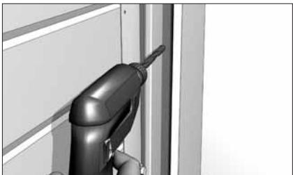
Установите задвижку на высоте, удобной для открывания. Разметьте отверстия для крепления.
