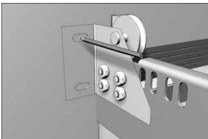
Разметьте и просверлите отверстия Ø8 мм в стене притолоки.
