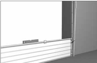
Затем по панели установите вертикальные направляющие. Расстояние от торцевой поверхности панели до кромок направляющих должно составлять около 25-30 мм.
