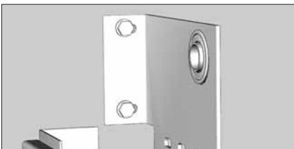
Просверлите намеченные отверстия в стене сверлом Ø12 мм, вставьте дюбели и закрепите кронштейн с помощью саморезов. Аналогично закрепите опорный кронштейн с другой стороны проема.
