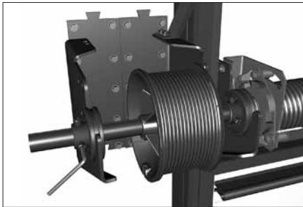
Зафиксируйте устройство от обрыва пружин. Затяните винты на концевых втулках.
