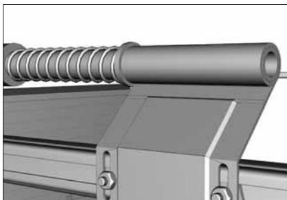
Закрепите амортизатор к с-профилю на обоих концах направляющих при помощи закладных пластин и болтов с гайками. Установите амортизатор таким образом, чтобы при открытых воротах он находился в сжатом состоянии не менее 50% от длины его хода.
