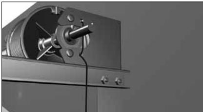
Второй конец фала закрепите в любом свободном отверстии угловой стойки или концевом опорном кронштейне.
