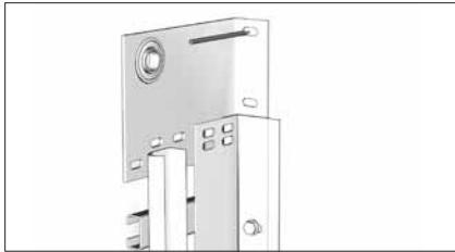
Установите концевой опорный кронштейн по отверстиям на угловой стойке и по перфорации в нем разместите отверстия для крепления в стене проема.
