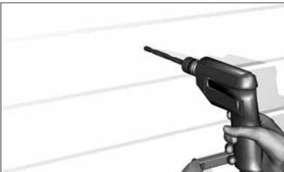
Просверлите 4 отверстия Ø10-12 мм.
