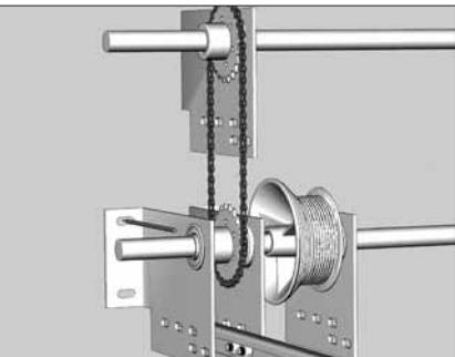
Установите дополнительный опорный кронштейн на нижний вал, для чего приставьте его к стене проема, наметьте и просверлите отверстия для крепления.
