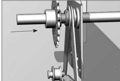
Устройство натяжения цепи предназначено для натяжения цепи при ее растяжении и гашения колебаний, возникающих в процессе ее эксплуатации.
