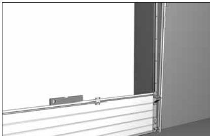
Выровняйте нижнюю панель по строительному уровню. При необходимости используйте подкладки соответствующей толщины.
