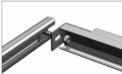
Закрепите с-профиль к концам горизонтальных направляющих с помощью закладных пластин и болтов с гайками.
