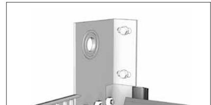
Установите опорный кронштейн вплотную к стене и угловой стойке, совместив при этом отверстия в опорном кронштейне, угловой стойке и кронштейне для крепления шкива.
