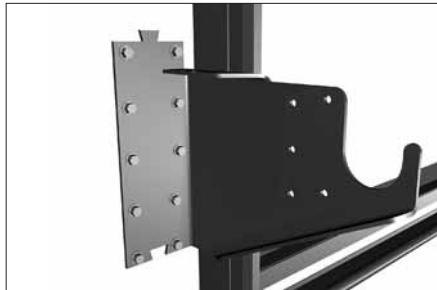
Прислоните выносной кронштейн для низкого вала к стене проёма вплотную к угловой стойке (с внешней стороны) согласно монтажной карте. По перфорации в кронштейне сделайте разметку для его крепления к стене.
