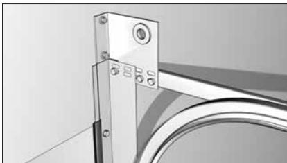
Установите концевой опорный кронштейн по отверстиям на угловой стойке. По перфорации в кронштейне разметьте отверстия для крепления в стене проема. Просверлите намеченные отверстия в с-профиле сверлом Ø8,5 мм и в стене сверлом Ø12 мм. Забейте в стену дюбели. К стене закрепите концевой опорный кронштейн при помощи саморезов. Скрепите концевой опорный кронштейн, с-профиль и угловую стойку между собой при помощи болтов M8x25 с гайками.
