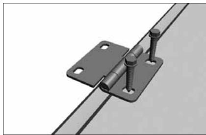
Закрепите петли при помощи саморезов для панелей ворот.
