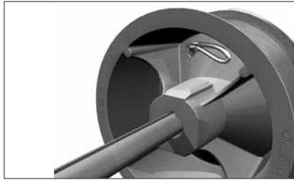
Разрежьте трос на две равные части. Пропустите свободный, не обжатый втулкой, конец троса через просверленное отверстие в барабане, протяните его вдоль направляющих и выведите к нижнему угловому кронштейну. Установите барабан к опорному кронштейну, намотайте на него трос на то количество витков, которое указано в монтажной карте. Закрепите барабан на вале крепежными болтами.
