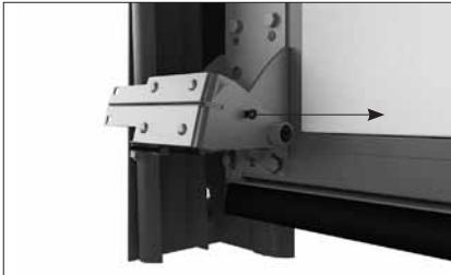
При использовании углового кронштейна с устройством защиты от обрыва троса разметьте и просверлите 6 отверстий 4,2 мм для крепления кронштейна. Закрепите его при помощи 6 саморезов 6,3x38 мм.
