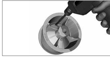
В случае отсутствия обжимного винта на барабане в боковой поверхности барабанов просверлите отверстие сверлом под диаметр троса для пропускания свободного конца троса.
