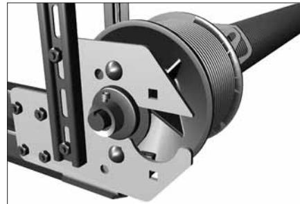
Установите на п-образные кронштейны тorsiонный механизм в сборе. При помощи 2x болтов с полукруглой головкой (M8X16) пластины концевую с подшипником закрепите к концевому опорному П-образному кронштейну. Закрепите устройство от обрыва пружины к концевому опорному П-образному кронштейну при помощи двух комплектов крепежных элементов (болт 10Х25, гайка M10, шайба 10 гроверная)
