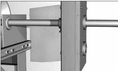
Установите на вал ручной цепной привода, предварительно вставив шпонку в шпоночный паз.
