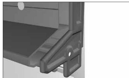
Снимите крышку профиля верхнего усилителя с одного из торцов профиля.
