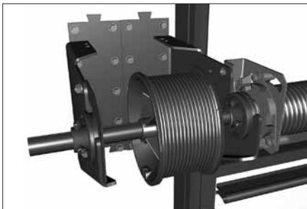
**Особенности монтажа двухвальной системы тorsионного механизма с выносным октогональным валом.**
