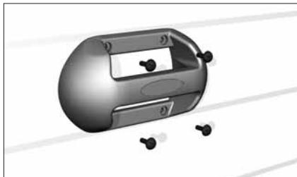
После этого закрепите ручку с помощью саморезов Ø4,8x35 мм, входящих в комплект ручки.
