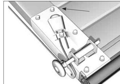
Закрепите устройство от обрыва пружины к концевому опорному П-образному кронштейну при помощи двух комплектов крепежных элементов (болт 10Х25, гайка M10, шайба 10 гроверная)
