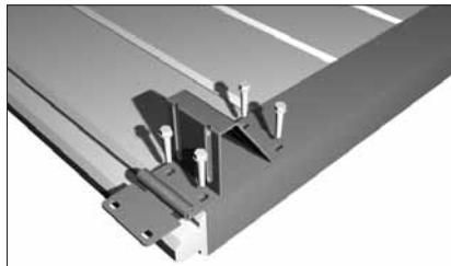
Установите боковые опоры по просверленным отверстиям, используя 4 самореза 6,3x38 мм.
