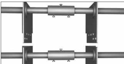
При использовании соединительных муфт опорные кронштейны устанавливаются с обеих сторон от муфт.
