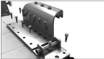
Установите нижний угловой кронштейн для барабана сзади на нижнюю панель. Разметьте и просверлите отверстия для крепления кронштейна сверлом Ø4.2 мм. Закрепите кронштейн при помощи саморезов.
