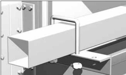
Закрепите трубу к кронштейнам с помощью скоб и гаек согласно монтажной карте.
