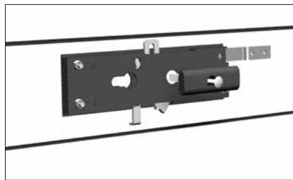
Установите наружную накладку и скрепите ее с корпусом замка при помощи трех винтов с гайками, входящих в комплект замка.
