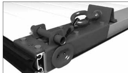
Установите нижний угловой кронштейн с устройством натяжения троса на нижнюю панель при помощи 6-ти саморезов. Заведите трос через овальную тарелку и закрепите на крюке.
