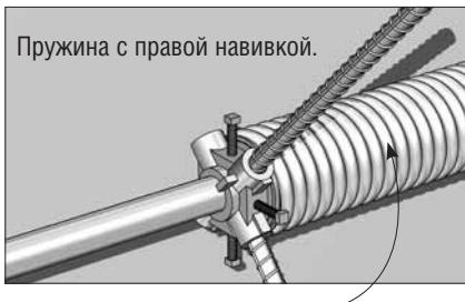
На пружине проведена краской специальная разметочная полоса, служащая для указания количества закрученных витков пружины. Расчетное число оборотов указано в монтажной карте.
