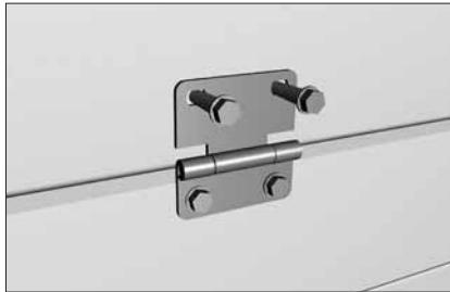
Закрепите верхние части петель с помощью саморезов для панелей.
