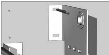
Симметрично с внутренней стороны установите второй опорный кронштейн, для чего приставьте его к стене проема и наметьте места его крепления к стене. Расстояние между кронштейнами должно быть таким, чтобы можно было разместить барабан.
