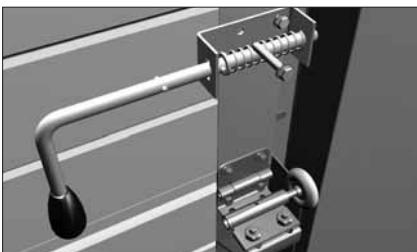
Закрепите задвижку к панели при помощи четырех саморезов. Проверьте работу задвижки.
