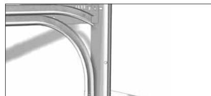
Горизонтальные направляющие поставляются в сборе. В них перфорированы отверстия для крепления с вертикальными направляющими.
