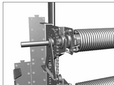
Установите натяжитель цепи на верхний вал и зафиксируйте его стопорным кольцом
