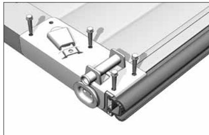
Установите нижние угловые кронштейны на нижнюю панель. Разметьте и просверлите отверстия Ø4,2 мм для его крепления. Закрепите кронштейн 4-мя саморезами 6,3x38 мм (как показано на рисунке).
