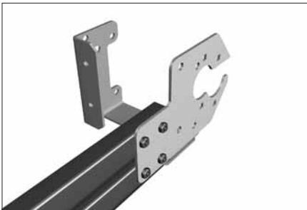
Установите на обе горизонтальные направляющие, соединенную конструкцию крепления кронштейна концевого опорного для барабана сзади и кронштейна крепления устройства безопасности для барабана сзади. Закрепите собранный кронштейн к двойным горизонтальным направляющим при помощи болтов 8Х16 с полукруглой головкой, затяните их гайками
