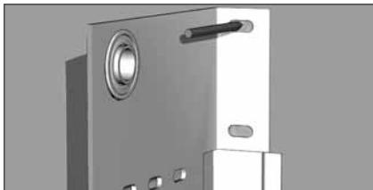
Установите опорный кронштейн вплотную к стене и угловой стойке, совместив при этом отверстия в кронштейне и стойке. Разметьте отверстия для крепления к с-профилю и стене проема по перфорации в опорном кронштейне.
