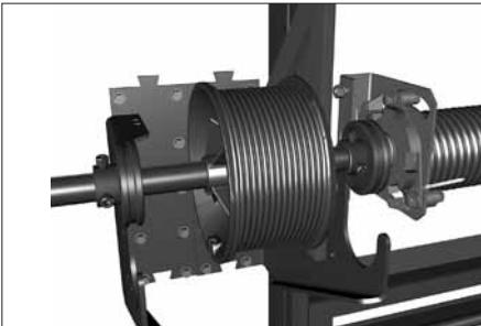
Установите торсионный механизм в пазы выносных кронштейнов позиционируя концевые втулки.
