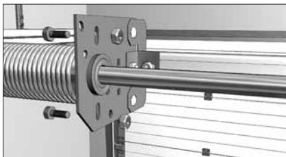
Закрепите пружину к кронштейну крепления для барабана сзади двумя болтами с гайками.
