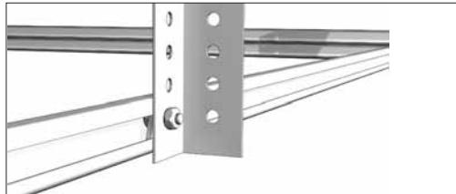
**A.** При высоте притолоки до 400 мм направляющие крепятся при помощи четырех угловых кронштейнов, скоб и болтов с гайками. Закрепите универсальный кронштейн на двойные направляющие с помощью скобы и болта с гайкой.
