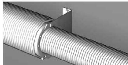
Торсионный механизм «пружина в пружине» устанавливается в случаях, когда высота проема больше, чем ширина проема в 1,5 раза и, как правило, на высокий или вертикальный подъем. В этом случае используются пружины с внутренним диаметром 152 и 95 мм.
