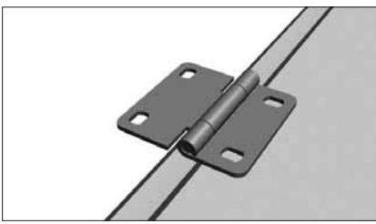
Установите внутренние петли по отверстиям в панели, ранее сделанным на производстве. Отверстия в нижней части петли должны совпадать с отверстиями в панели, сделанными на производстве.
