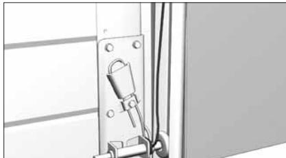
Один конец капронового фала закрепите к втулке ролика на нижнем угловом кронштейне.
