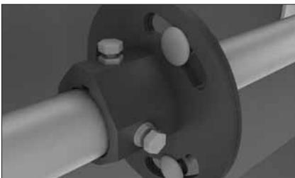
Ослабьте болты соединяющие две части муфты. Отрегулируйте натяжение тросов путем вращения двух частей вала. Зафиксируйте новое положение муфты при помощи болтов с гайками.
