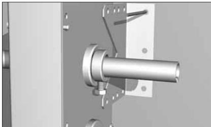
Приставьте кронштейн крепления ручного цепного привода вплотную к стене проема и к приводу. Разметьте отверстия для крепления кронштейна на стене.
