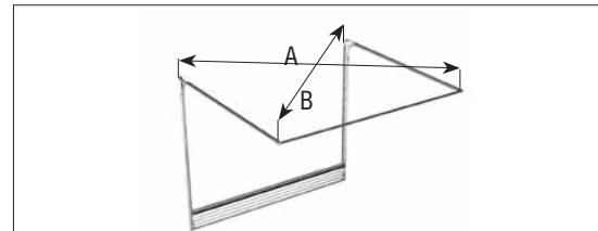
Проверьте горизонтальность направляющих с помощью строительного уровня (при необходимости отрегулируйте). Перед окончательным креплением направляющих к потолку необходимо проверить расстояние между противоположными углами (диагонали А и В должны быть одинаковы).
