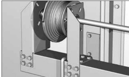
Вставьте вал с пружиной в подшипники кронштейнов и установите барабаны.
