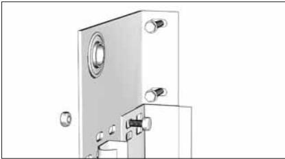
Просверлите намеченные отверстия в стене сверлом Ø12 мм. Забейте в стену дюбели. Скрепите концевой опорный кронштейн и угловую стойку между собой при помощи болтов M8x25 с гайками.
