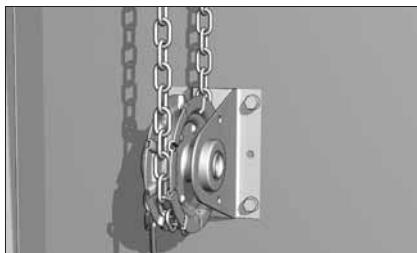
Проденьте цепь через привод и натяжной ролик.
