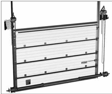
Закрепите вал с помощью крюков, возле барабанов, зацепив их за грузовой крюк тали, предварительно на втулке концевой для вала 1,25" торсионного механизма отпустите шестигранные винты 8Х16, так что - бы втулку можно было свободно перемещать по валу.
