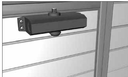
Установите корпус доводчика по 4 отверстиям, просверленным на производстве в полотне калитки.
