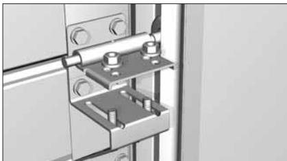
На боковые опоры установите роликодержатели с роликами.
