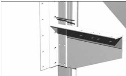
Прислоните выносной кронштейн для низкого вала к стене проема вплотную к угловой стойке (с внешней стороны) согласно монтажной карте. По перфорации в кронштейне сделайте разметку для его крепления к стене и угловой стойке.
