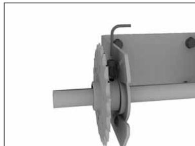
Установите на верхний и нижний валы звездочки таким образом, чтобы они располагались на одной линии. Предварительно наденьте на них цепь. Если межцентровое расстояние между валами (A) меньше 393 мм, то согласно таблице 1 укоротите цепь. Аналогично установите звездочки с другой стороны проема.
