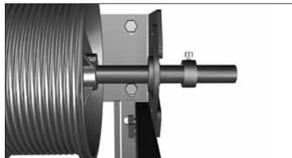
Установите торсионный механизм в сборе таким образом, чтобы пластина концевая с подшипником располагалась заподлицо с внешней стенкой кронштейна. Оцените на вал стопорное кольцо вплотную к подшипнику.
