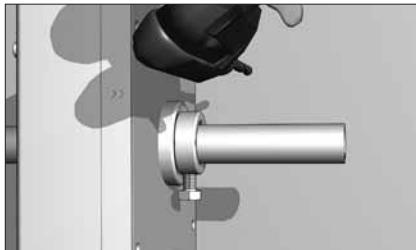
Просверлите размеченные отверстия сверлом Ø12 мм.
