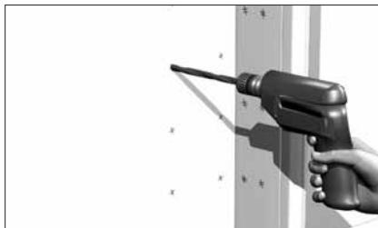
Просверлите по разметке в стене проема десять отверстий сверлом Ø12 мм и восемь отверстий в угловой стойке сверлом Ø7 мм.
