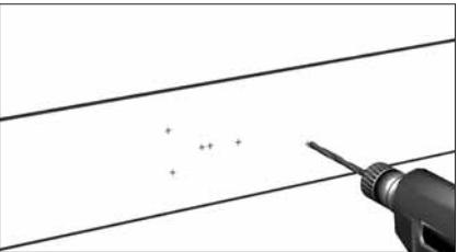
Откройте ворота и просверлите отверстие Ø15 мм в угловой стойке для входления ригеля замка.
