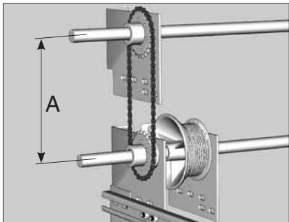
Установите на второй вал звездочку таким образом, чтобы она располагалась на одной линии с нижней звездочкой. Предварительно наденьте на них цепь. Если межцентровое расстояние между валами (A) меньше 393 мм, то согласно таблице 1 укоротите цепь. Зафиксируйте верхнюю звездочку на валу крепежными болтами. Аналогично установите звездочку и цепь с другой стороны проема.
