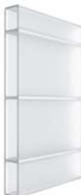
HEATSTOP представляет собой двухслойный сотовый лист, отражающий инфракрасное излучение, изготовленный из ударномодифицированного полиметилметакрилата (ПММА). На этом сотовом листе покрытие равномерно распределено и интегрировано в объем листа. HEATSTOP обладает большей ударной прочностью по сравнению с обычным сотовым оргстеклом. Материал имеет антикапельное покрытие, на которое наносится специальный защитный слой.
