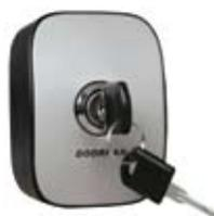
Ключ-кнопка KEYSWITCH используется для подачи сигнала на блок управления приводом. Наличие микропереключателя позволяет управлять воротами в пошаговом режиме - открывать, закрывать и останавливать их. Для подачи нужной команды необходимо повернуть ключ.
