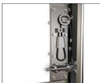
Устройство защиты от разрыва троса. При обрыве троса или попытке несанкционированного подъема ворот устройство зацепляется за накладку, установленную на стойке ворот. При этом полотно блокируется. Таким образом предотвращается падение ворот или их несанкционированный подъем.
