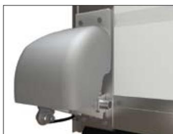
Механизм защиты от обрыва троса, оборудованный защитным кожухом, устанавливается в качестве нижнего кронштейна на полотно. В случае выхода из строя троса механизм защиты останавливает ход полотна ворот, фиксируясь в направляющую.
