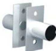
Магнитный бесконтактный датчик открытой калитки предназначен для предотвращения запуска привода, когда калитка открыта. При открытии калитки магнит и считыватель смещаются относительно друг друга, контакт размыкается, и блок управления не допускает запуск привода.
