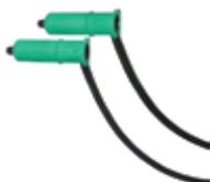
Оптико-электронные датчики Optokit состоят из двух инфракрасных датчиков безопасности - приемника и передатчика. Оба датчика проложены в резиновом профиле. Когда резиновый профиль деформирован, оптический луч прерывается и подается сигнал блоку управления, который осуществляет остановку или реверс ворот.
