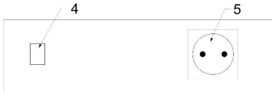
Під'єднати навантаження до стабілізатора у розетку (5) на задній частині корпусу. Під'єднати стабілізатор до мережі вимикачем (4) увімкнути прилад. Після 5 сек затримки, якщо немає аварій й напруга
