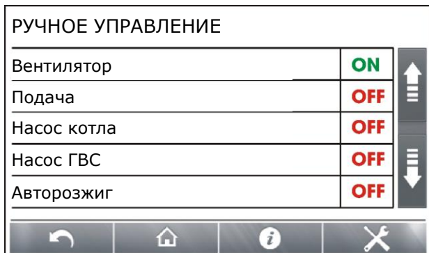
Рис. 8 Вид окна ручного управления, где OFF – означает, что устройство выключено, ON – включено.
