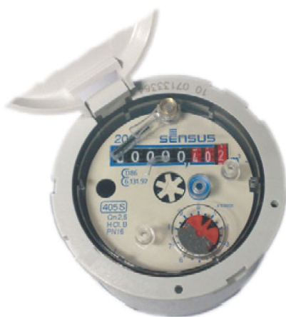
Счетный механизм 405S (DN 15 - DN 20, пластик)
