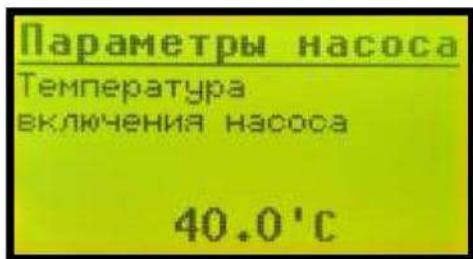
Температура, при достижении которой происходит включение циркуляционного насоса отопительной системы.
