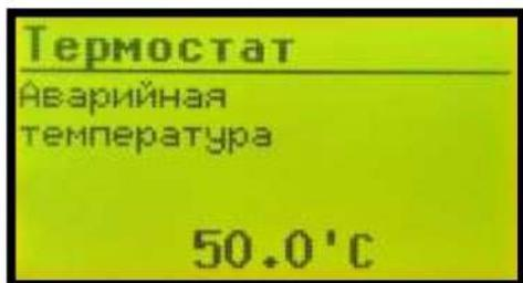
Аварийный порог температуры, при достижении которого горелка немедленно перейдет в режим Чистки с последующим переходом в режим АВАРИЯ.
