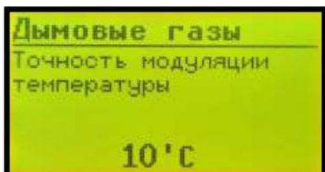
В режиме работы модуляция или нагрев/поддержка при достижении верхнего порога температур, горелка снижает мощность до минимальной но не выключается, что может привести к перегреву. Данное значение прибавляется к установленной температуре верхнего порога и при достижении суммарного значения переводит горелку в режим Дожига с последующим переходом в режим Ожидания.
