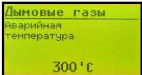
Аварийный порог температуры, при достижении которого горелка немедленно перейдет в режим Чистки с последующим переходом в режим АВАРИЯ.
