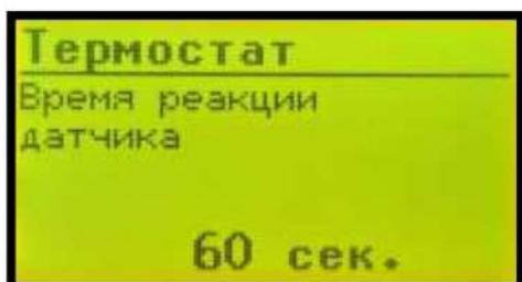
Время задержки отработки команд старт или стоп при достижении пороговых значений установленной температуры. Применяется для исключения ложных срабатываний по причине кратковременных колебаний температуры в помещении, (открытие двери и пр.)
