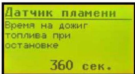
порога, при котором считается что горелка горит. Данный параметр является нижним порогом при работе по температуре дымогазов. Снижение температуры ниже заданного значения означает затухание горелки.
