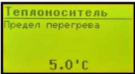
В режиме работы модуляция или нагрев/поддержка при достижении верхнего порога температур, горелка снижает мощность до минимальной но не выключается, что может привести к перегреву. Данное значение прибавляется к установленной температуре верхнего порога и при достижении суммарного значения переводит горелку в режим Дожиг с последующим переходом в режим Ожидание.
