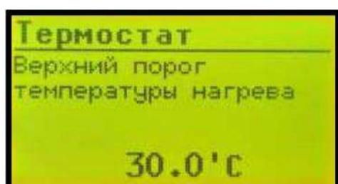
Верхний порог температуры нагрева помещения (теплицы) в котором размещен датчик термостата.
