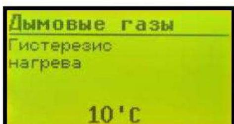
Гистерезис мощности в режиме нагрев/поддержка. Если к примеру, установка верхнего порога температуры равна 120 С, а установка гистерезиса равна 30 С, то переход из минимальной мощности горелки на максимальную произойдет при температуре 90 С.
