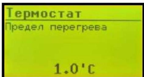
В режиме работы модуляция или нагрев/поддержка при достижении верхнего порога температур, горелка снижает мощность до минимальной но не выключается, что может привести к перегреву. Данное значение прибавляется к установленной температуре верхнего порога и при достижении суммарного значения переводит горелку в режим Дожиг с последующим переходом в режим Ожидания.
