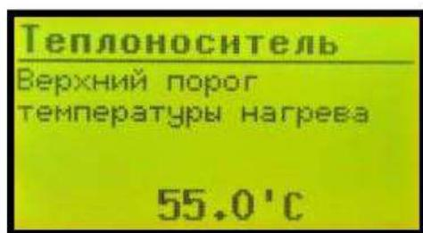
Верхний порог температуры нагрева теплоносителя.
