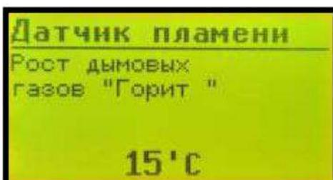
Время фиксации розжига по датчику дымовых газов, в течении этого времени температура не должна падать ниже температуры затухания дымовых газов.
