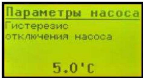
Гистерезис отключения циркуляционного насоса. Если к примеру, установка температуры включения насоса равна 40.0 С , а установка гистерезиса равна 5.0, то отключение произойдет при температуре 35.0 С.
