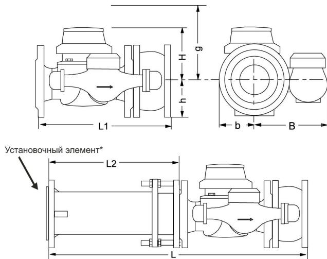
4.9. Счетчик воды устанавливается после завершения строительных и монтажных работ, очистки и промывки трубопровода, проведения испытания давлением. При промывке и испытании давлением счетчик должен быть заменен соответствующей вставкой.
