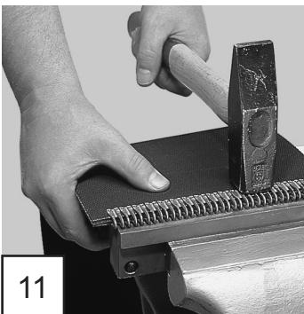
Gurtverbindeapparat bis auf Gurtoberfläche schließen. Die gleiche Seite der Oberfläche muss immer zum Bediener zeigen.
