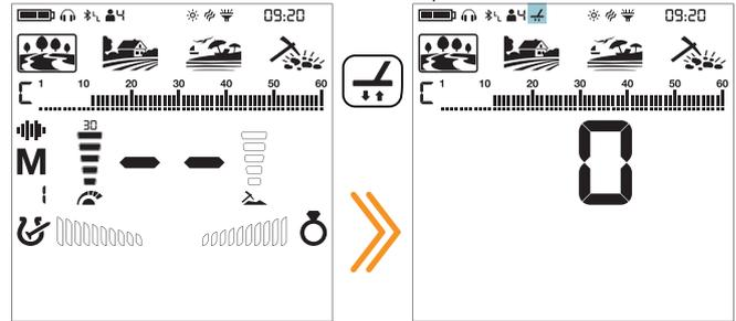
3. Вам нужно слушать звуки от грунта для того, чтобы выполнить ручной баланс грунта. Двигайте катушкой вниз и вверх на 15-20 см, не доходя до уровня земли 3 см. Движения должны быть плавными, катушку держите параллельно земле.
