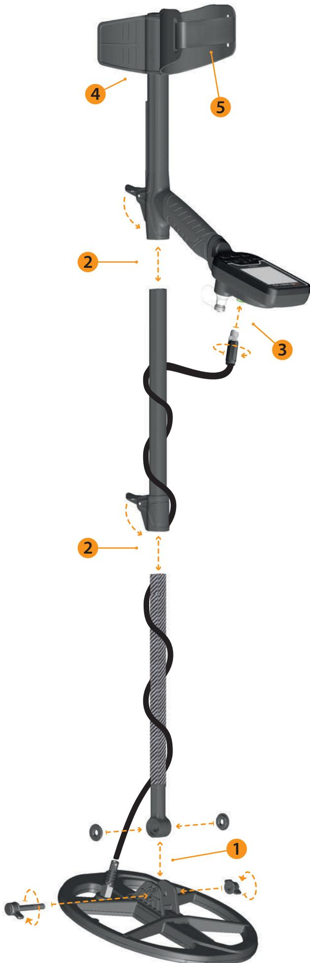
(1) После установки шайб на нижнюю катушку соедините нижнюю штангу с поисковой катушкой. Закрепите, затянув винт и гайку. Не затягивайте слишком сильно.
