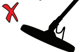
Неправильный угол наклона поисковой катушки
