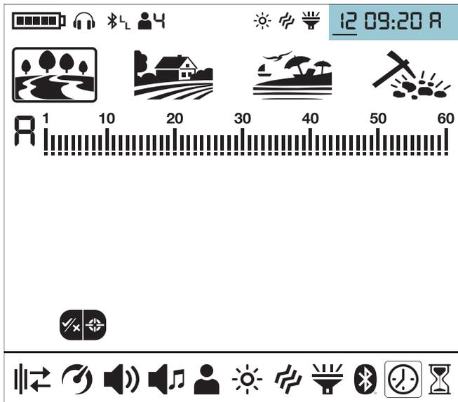
4. Затем с помощью правой и левой кнопок выберите час и минуты и установите время с помощью кнопок плюс (+) и минус (-).
