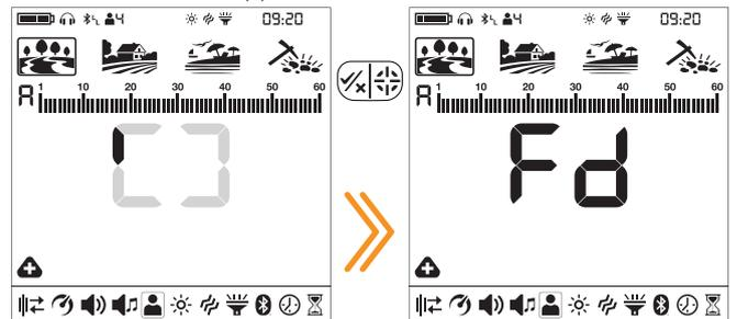
4. Выберите значок сброса и нажмите и удерживайте кнопку "Пинпойнт и Принять/Отклонить", чтобы сбросить профиль пользователя. Флажок в профиле значка пользователя исчезнет.
