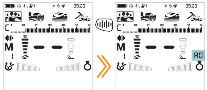
Даже если звук отключен, устройство автоматически вернется к включенному режиму в меню выборочной дискриминации (notch), баланса грунта и настроек.
