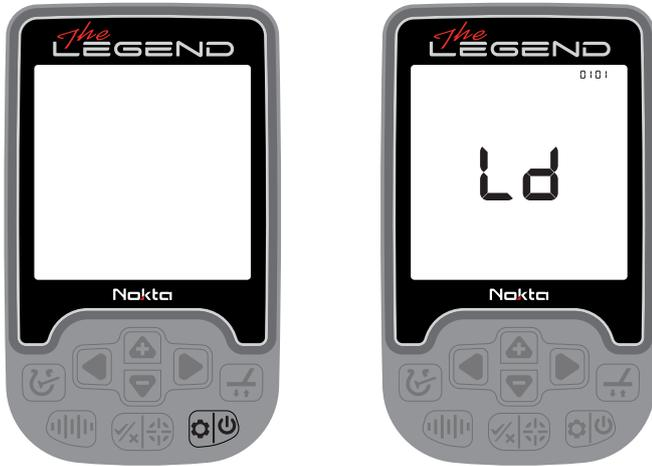
3. Когда устройство включено, оно запустится в режиме Парк и на мультиточастоте. Вы можете изменить режим в зависимости от условий местности. Более подробную информацию о режимах и частотах поиска вы можете найти далее в этом руководстве.
