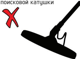
Неправильный угол наклона поисковой катушки
