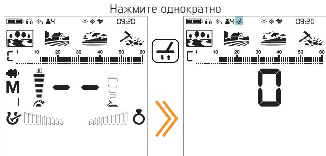
3. Вам нужно слушать звуки от грунта для того, чтобы выполнить ручной баланс грунта. Двигайте катушкой вниз и вверх на 15-20 см, не доходя до уровня земли 3 см. Движения должны быть плавными, катушку держите параллельно земле.
