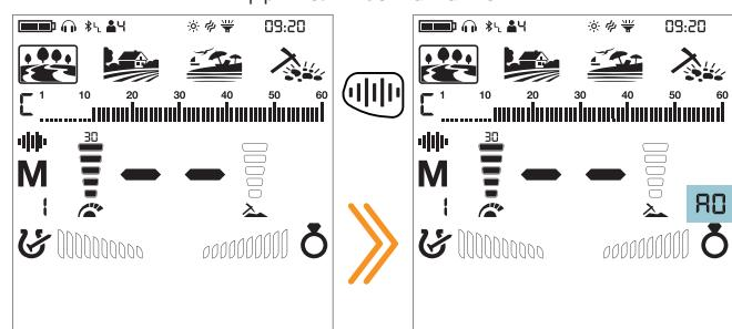
Даже если звук отключен, устройство автоматически вернется к включенному режиму в меню выборочной дискриминации (notch), баланса грунта и настроек.
