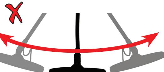
Важно держать поисковую катушку параллельно земле, чтобы получить точные результаты.
