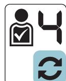
4. Выберите значок сброса и нажмите и удерживайте кнопку "Пинпойнт и Принять/Отклонить", чтобы сбросить профиль пользователя. Флажок в профиле значка пользователя исчезнет.
