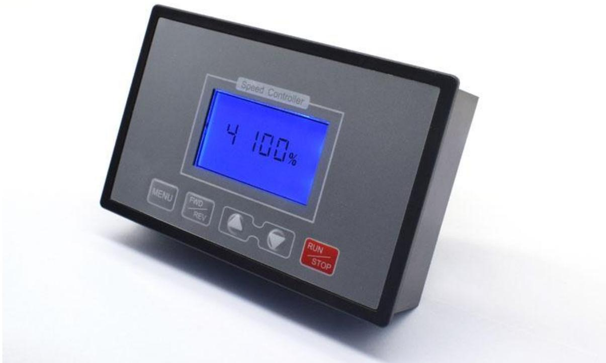
Настройка значения ускорения /замедления Нажмите клавишу МЕНЮ 6 для входа в функцию 5 поверхность клавиши Нажмите клавишу плюс / минус для переключения Нажмите RUN / STOP для сохранения и выхода
