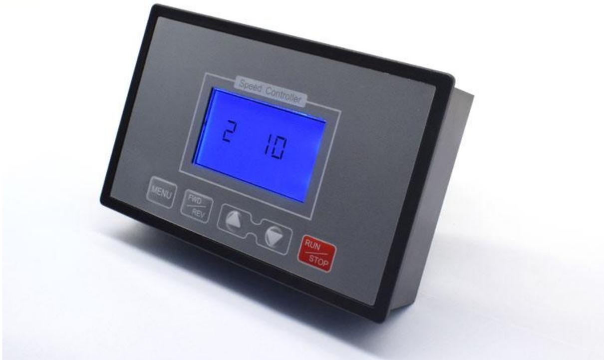
Настройка нижнего предела скорости Нажмите клавишу МЕНЮ 4 для входа в функцию 3 поверхность клавиш Нажмите клавиши плюс и минус для установки Нажмите RUN / STOP для сохранения и выхода
