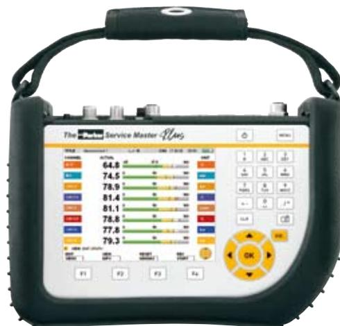
Измерение давления, расхода и температуры с помощью The Parker Service Master *Easy* или *Plus* и гидравлического тестера SCLV-PTQ
