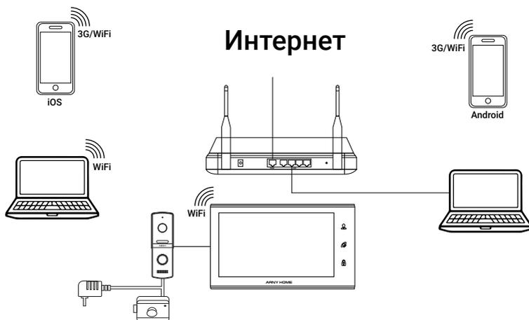
Большинство параметров домофона можно настроить с помощью мобильного приложения ARNY Home, установленного на мобильном устройстве (смартфоне или планшете) под управлением iOS/Android, или через браузер Internet Explorer на компьютере под управлением ОС Windows.
