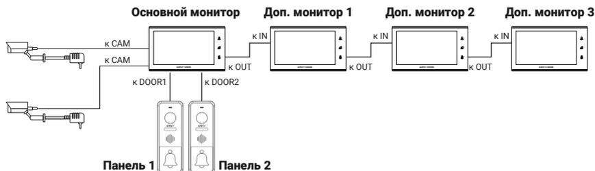
Вызывные панели и камеры подключаются только к основному монитору.
