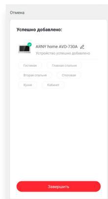
Для добавления монитора, который уже подключен к сети Интернет, выберите вкладку «Автоматическое сканирование», как показано на среднем рисунке выше. Приложение автоматически обнаружит подключенные устройства и отобразит их значки на экране. После выбора устройства откроется окно, в котором можно изменить имя устройства, указать комнату, в которой оно будет установлено и завершить процедуру добавления – пример показан на рисунке выше справа.
