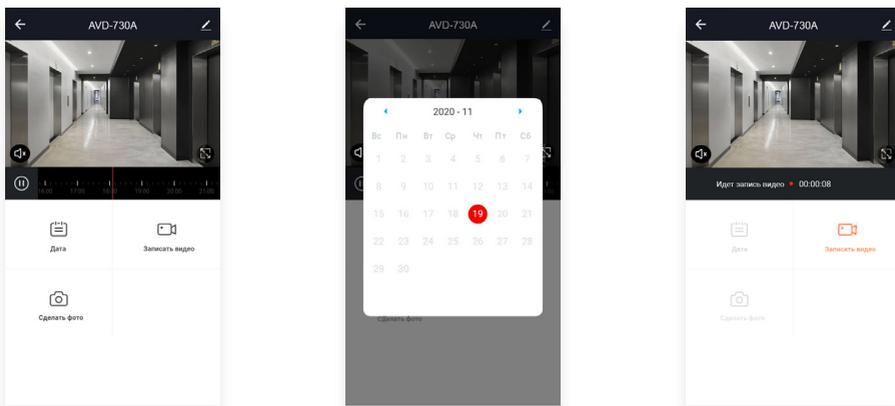
Сразу после открытия автоматически включится просмотр видеозаписей, начиная с самой ранней за текущий день. В левом нижнем углу изображения расположена кнопка включения/выключения звука, а в правом нижнем углу изображения – кнопка разворота изображения на весь экран.
