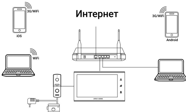
Монитор может быть подключен к сети (роутеру) как беспроводное устройство:
