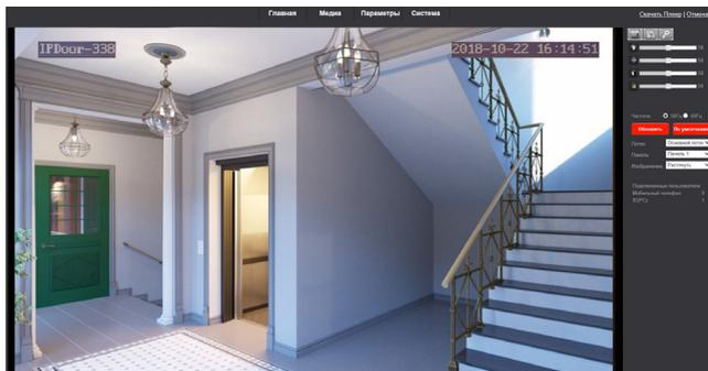
В верхней части страницы расположены кнопки разделов веб-интерфейса: «Главная» (страница), «Медиа», «Параметры» и «Система». В правом верхнем углу находятся кнопки «Скачать плеер» и «Отмена». Кнопка «Скачать плеер» позволяет начать загрузку плагина ActiveX, кнопка «Отмена» завершает сеанс связи с домофоном и открывает страницу авторизации.
