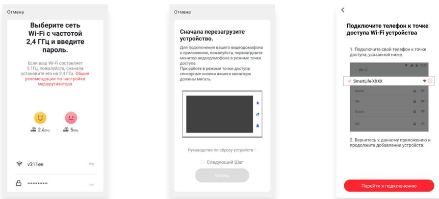
5) После подключения смартфона к точке доступа «SmartLife-XXXX» нужно вернуться в приложение ARNY Home, в котором запустится процедура сопряжения монитора с указанной точкой доступа Wi-Fi, после чего произойдет автоматическая регистрация устройства на сервере и его привязка к аккаунту текущего пользователя ARNY Home:
