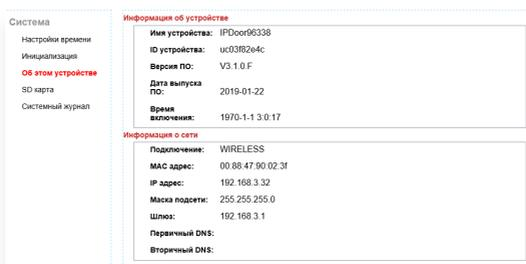
Здесь отображается следующая информация об устройстве: 1) имя устройства; 2) облачный UID устройства; 3) версия ПО; 4) дата выпуска ПО; 5) время включения IP-домофона; 6) тип подключения: проводной (LAN) или беспроводной (Wireless); 7) MAC-адрес; 8) IP-адрес; 9) маска подсети; 10) IP-адрес шлюза; 11) IP-адрес первичного DNS; 12) IP-адрес вторичного DNS.
