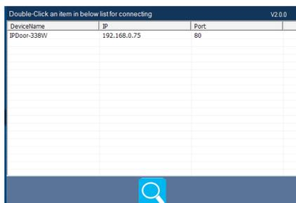
Сразу после запуска утилита выполняет автоматический поиск мониторов ARNY в сети и выводит на экран список найденных устройств с указанием их IP-адресов и портов http. При необходимости можно запустить поиск вручную, нажав на значок лупы под списком. Двойной клик по адресу устройства открывает его в браузере.
