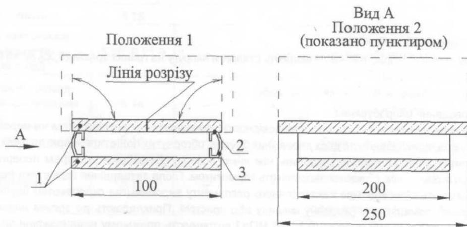
1 - скло; 2 - герметик первого шару герметизации; 3 - дистанционная рамка Рисунок 8 - Випробування герметика первого герметизуючого шару
