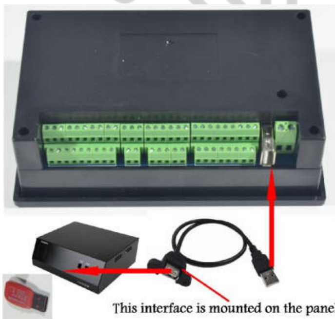
Рисунок 2-4. Эскиз-схема USB интерфейс удлинительный кабель USB
