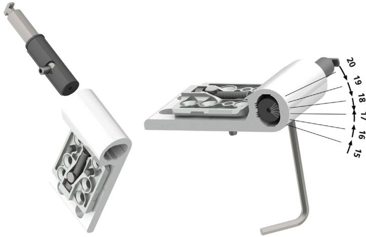
4. Отрегулировать каретку створочной части, согласно принятой ранее предустановке.
