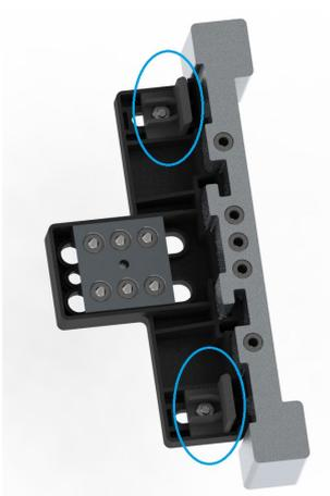
Используя регулировки, описанные выше, настраиваем кондуктор исходя из предустановки петли, ширины створки, высоты наплава, а также желаемого места крепления петли в раму.
